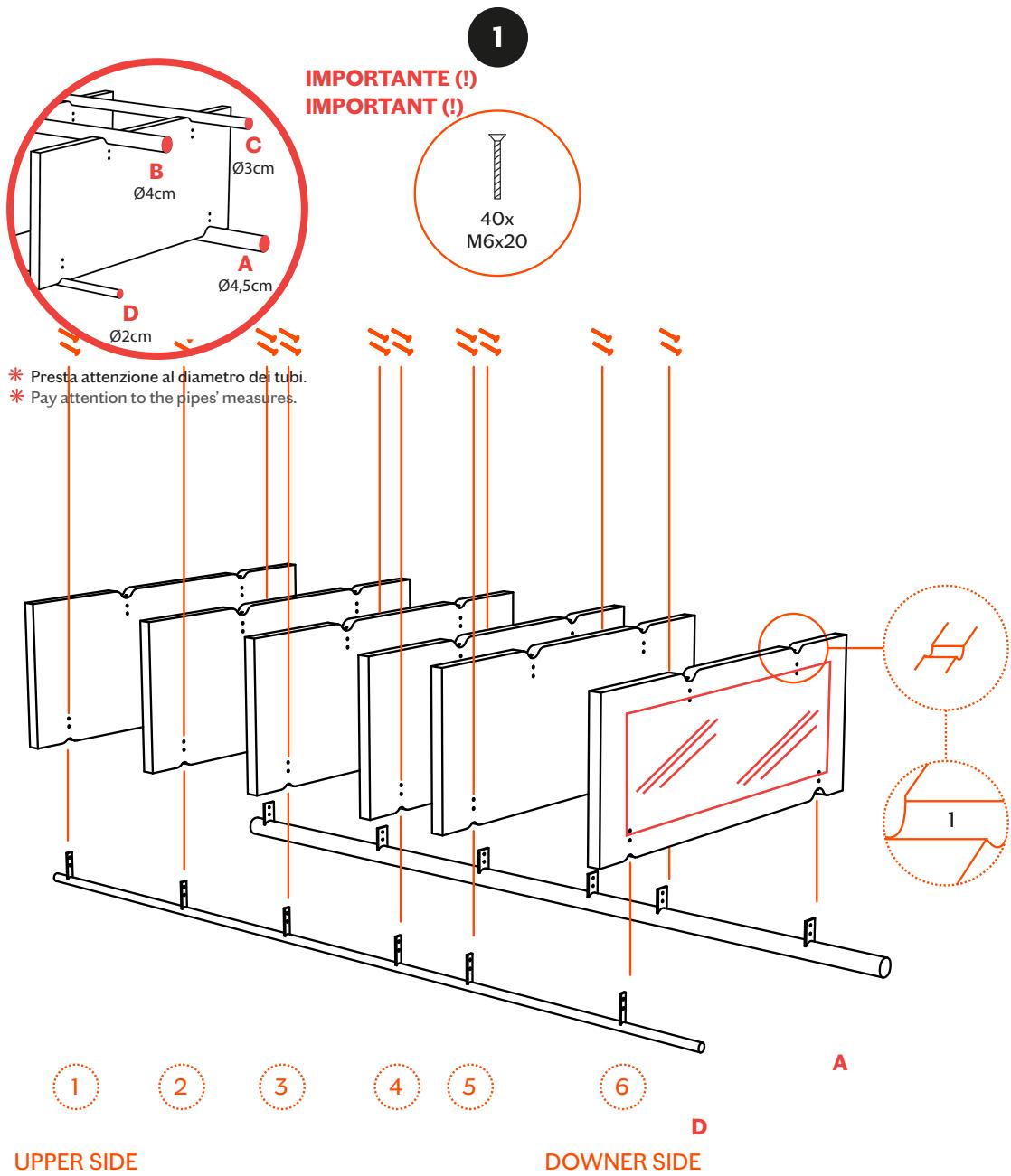
Appoggiati ad un piano orizzontale. Inserisci e avvita una mensola alla volta nei tubi corrispondenti, seguendo l'ordine numerico indicato sulle scalanature delle mensole (1-5).\*
